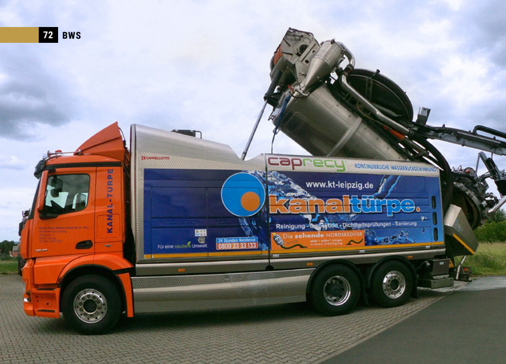
Fahrzeug zur Kanalreinigung mit Wasserrückgewinnung.
