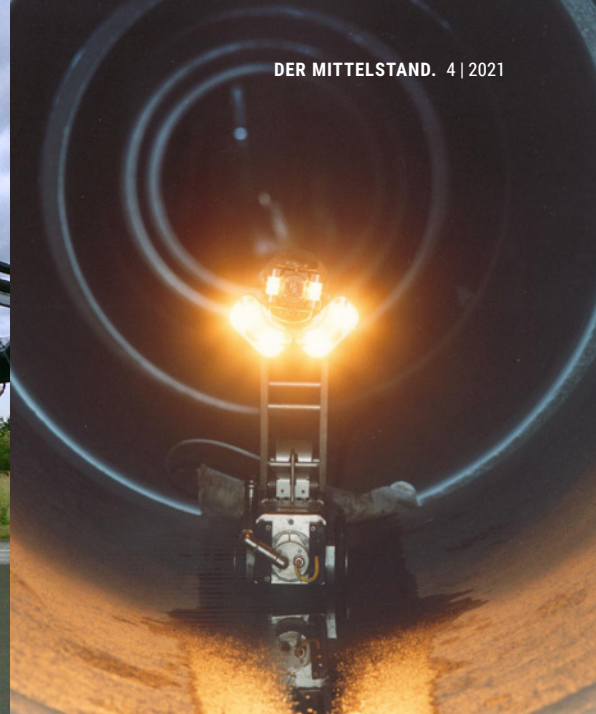
Kanal-Fernsehkamera zur Inspektion von Abwasserkanälen.
